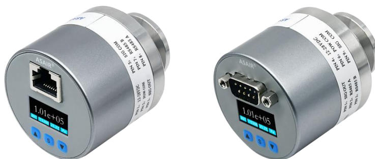
图1. AGP3系列皮拉尼复合真空计实物图（左侧为AGP3100，右侧为AGP3200）
