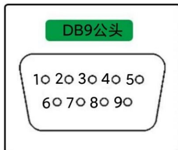
图4. DB9公头针脚示意图
